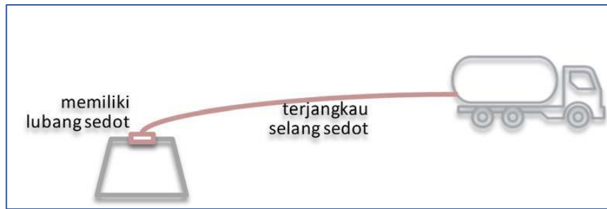
Gambar 2.4. 1 Penyedotan Lumpur Tinja dengan Selang Sedot
